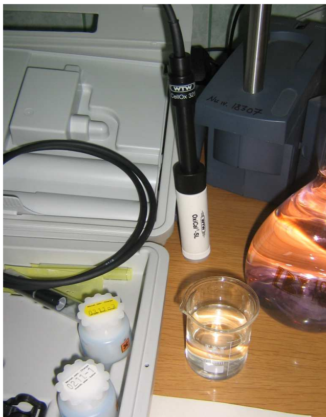
Figura 1. Senzorul de oxigen CelIOX 325
