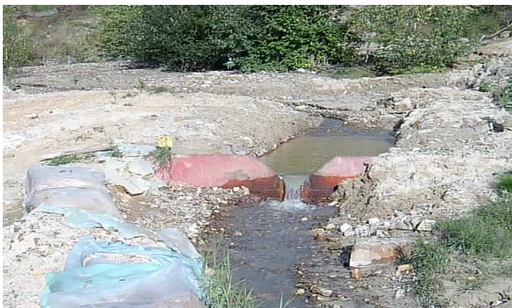
Fig. 12 Deversor triunghiular măsurare debite mici
