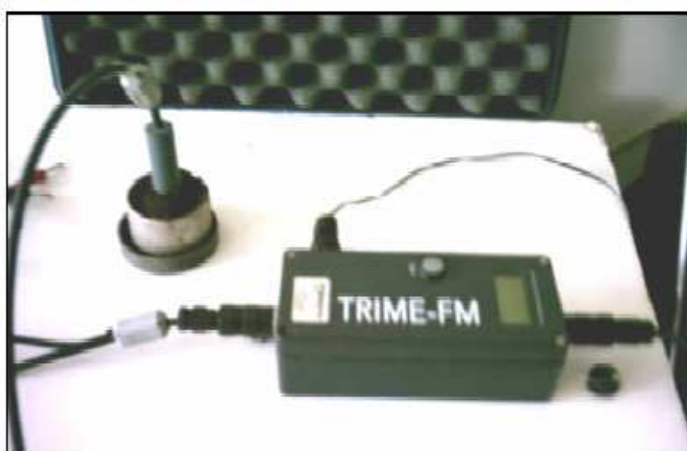
Fig. 2 Aparatul Trime-FM, cu sonda în poziție de lucru și cablul de comunicații seriale montat
